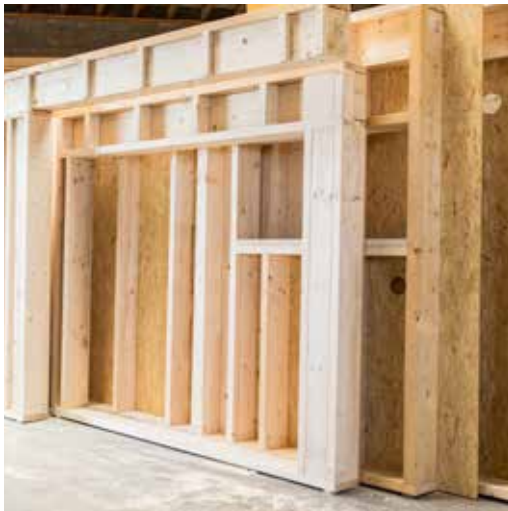
Vormontage der Wände im Werk
